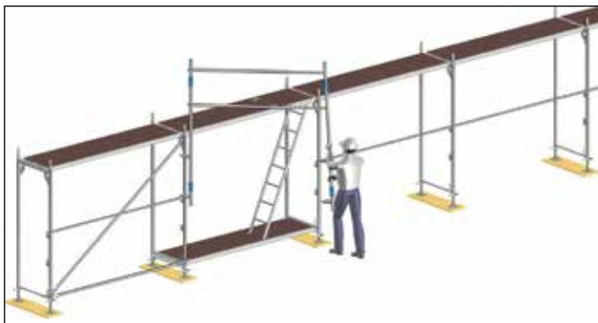
Bild 24: Montering av montereräcke
