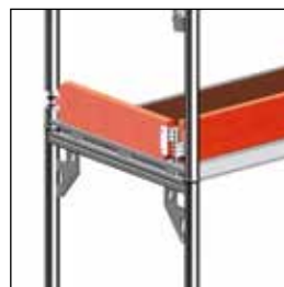
Bild 34: Montering av sparklister
