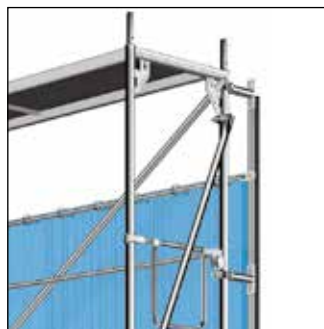
Bild 117: Utförande med ställningsduk
