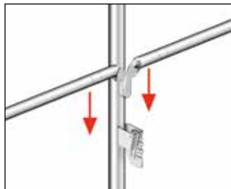
Bild 30: Montering av enkelräcke
