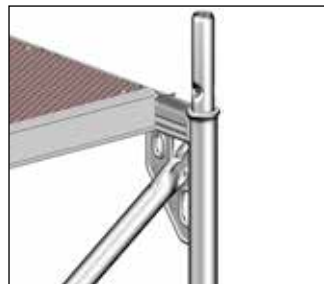
Bild 27: Diagonalstag monterat i ramens hörnplåt
